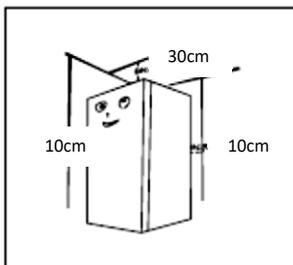
Der obere Raum des Kühlschranks muss größer als 30 cm sein, und die Abstände von beiden Seiten und der Rückseite müssen mehr als 10 cm betragen, um das Öffnen und Schließen und die Wärmeabfuhr zu erleichtern.
