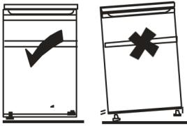
**WICHTIG:** Der Kühlschrank oder Gefrierschrank muss so aufgestellt werden, dass alle FüÙe fest auf dem Boden stehen.
