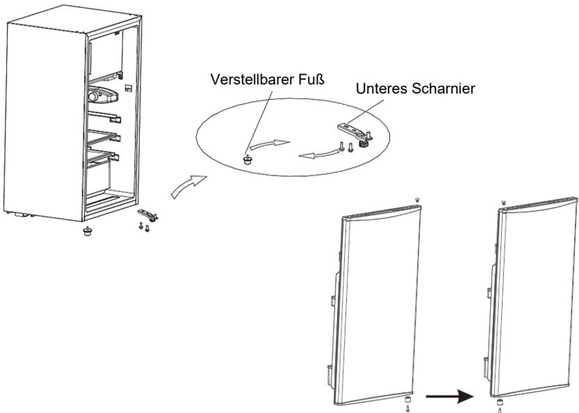
5. Setzen Sie die Tür auf das untere Scharnier und montieren Sie nacheinander das obere Scharnier, die obere Scharnierabdeckung und die Kunststoffschrauben.
