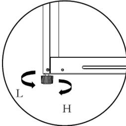
Stellen Sie die NivellierfüÙe ein, um die richtige Position des Geräts einzustellen. Das Gerät muss aufrecht und stabil stehen!
