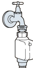
Tubo di alimentazione di sicurezza
