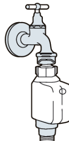
Tubo di alimentazione di sicurezza
