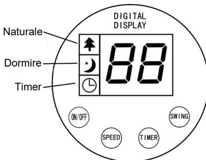
**Nota:** Il telecomando ha le stesse funzioni del pannello di controllo, ad eccezione della funzione MODE che è possibile solo tramite il telecomando.
