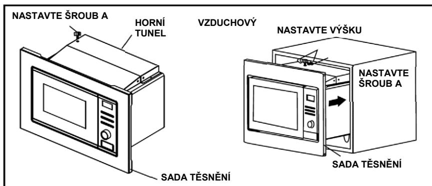
1. Upevněte NASTAVOVACÍ ŠROUB A V HORNÍM VZDUCHOVÉM TUNELU trouby a poté troubu nainstalujte do skříňky.
