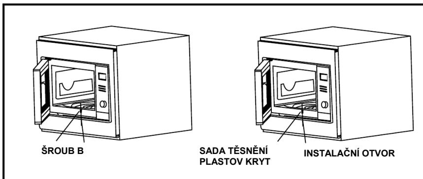
2. Otevři dveře; upevněte troubu do skříňky pomocí **ŠROUBY B** do **INSTALAČNÍHO OTVORU** z **SOUPRAVY TĚSNĚNÍ**. Potom připevněte **PLASTOVÝ KRYT TĚSNICÍ SOUPRAVY** k **INSTALAČNÍMU OTVORU**.
