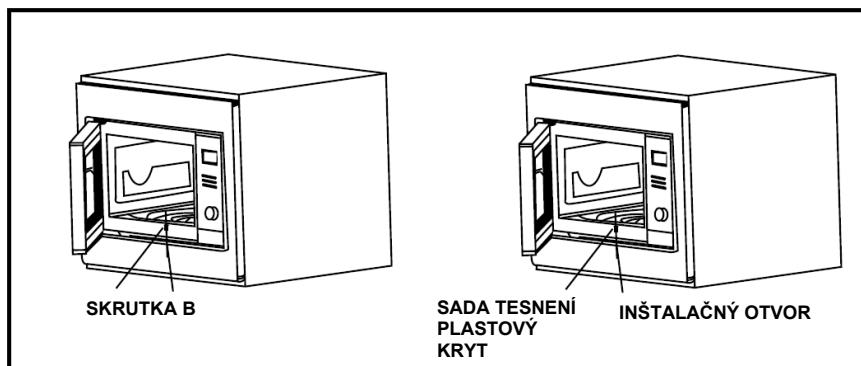
2. Otvor dvere; upevnite rúru do skrinky pomocou **SKRUTKY B** do **INŠTALAČNÉHO OTVORU** z **SÚPRAVY TESNENIA**. Potom pripojte **PLASTOVÝ KRYT TESNIACEJ SÚPRAVY** k **INŠTALAČNÉMU OTVORU**.
