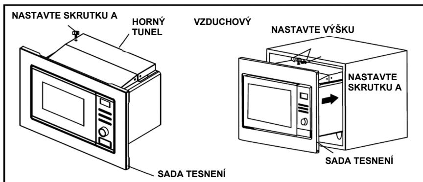
1. Upevnite NASTAVOVACIU SKRUTKU A v HORNOM VZDUCHOVOM TUNELI rúry a potom rúru nainštalujte do skrinky.
