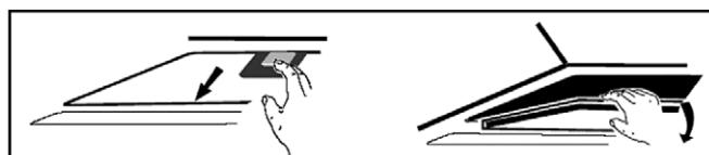
Stavite filter s aktivnim ugljenom u uređaj i okrenite ga u smjeru kazaljke na satu. Ponovite isto na drugoj strani.
