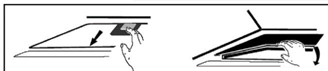
Stavite filter s aktivnim ugljenom u uređaj i okrenite ga u smeru kazaljke na satu. Ponovite isto na drugoj strani.
