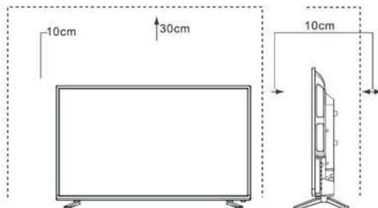
Stellen Sie das Fernsehgerät auf eine feste und ebene Fläche, wobei ein Abstand von mindestens 10 cm um das Gerät herum und 30 cm von der Oberkante des Geräts zur Wand eingehalten werden muss.
