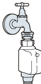
Tubo di alimentazione di sicurezza
