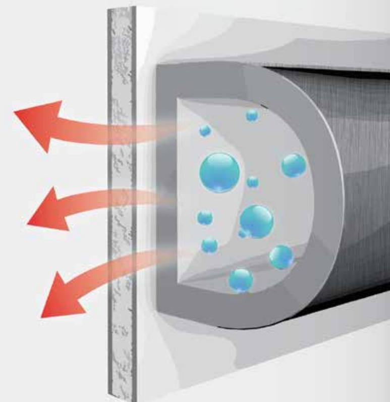
Pravilan raspored isparivača omogućava ravnomjerno zamrzavanje svih namirnica bez obzira na njihov raspored ili položaj unutar zamrzivača.
