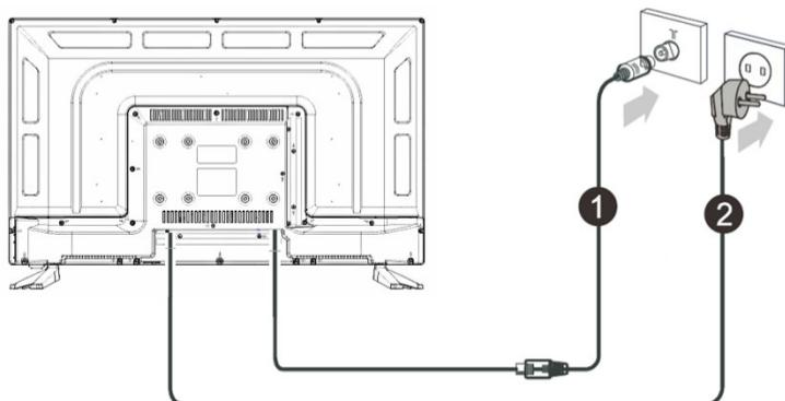
1. Collegare il cavo dell'antenna al terminale di ingresso dell'antenna sul pannello posteriore e sulla presa dell'antenna da parete.
