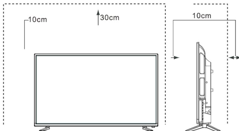
Posizionare il televisore su una superficie solida e piana, lasciando lo spazio di minimo 10cm attorno al televisore e 30cm dalla parte superiore del televisore alla parete.
