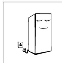
Der Kühlschrank sollte 2 bis 3 Stunden laufen, bevor frische oder gefrorene Lebensmittel eingelegt werden; im Sommer sollte der Kühlschrank länger als 4 Stunden laufen, da die Umgebungstemperatur hoch ist.
