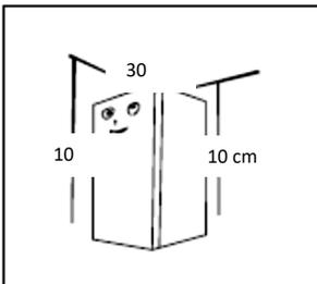
Der obere Bereich des Kühlschranks muss größer als 30 cm sein und die Abstände zu beiden Seiten und zur Rückseite müssen mehr als 10 cm betragen, um das Öffnen und Schließen sowie die Wärmeableitung zu erleichtern.
