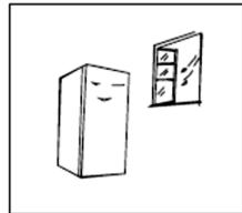
Der Kühlschrank wird an einem gut belüfteten Ort im Innenbereich aufgestellt. Der Boden muss eben und stabil sein (bei Instabilität das Rad nach links oder rechts drehen, um die Nivellierung anzupassen).
