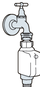
Bezpieczny wąż zasilający Aqua-Stop (opcjonalnie)
