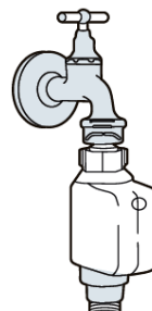
Tubo di alimentazione di sicurezza
