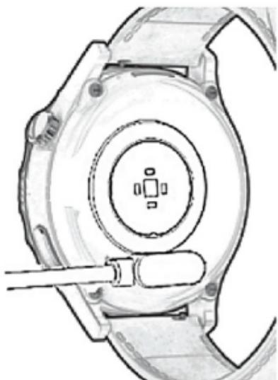
Aby se zajistil dobrý kontakt nabíjení, udržujte kovový kontakt bez nečistot, oxidace a jakýchkoli druhů znečištění. Pokud je zařízení delší dobu nečinné, nezapomeňte jej alespoň jednou za měsíc dobít.
