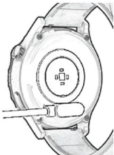
Za zagotovitev dobrega polnilnega kontakta naj bo kovinski kontakt čist od umazanije, oksidacije in nečistoč. Če naprava dlje časa ne deluje, ne pozabite napolniti vsaj enkrat na mesec.
