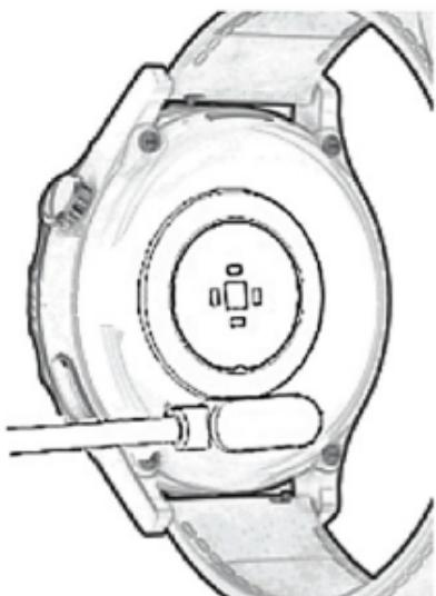
W celu zapewnienia dobrego kontaktu ładowania, prosimy o utrzymywanie metalowego kontaktu wolnego od brudu, utleniania i zanieczyszczeń. Jeśli urządzenie jest nieużywane przez dłuższy czas, proszę pamiętać o ładowaniu co najmniej raz w miesiącu.
